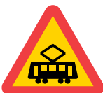
A37 Varning för korsning med spårväg
